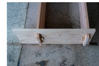
③ クサビを差し込む 側面の穴にクサビの細い側を下にして2本差し込む。
