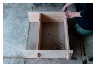
④ 反対側も同様に 本体を横にした状態で、反対側も同様に側板んに天板とクサビを差し込む。
